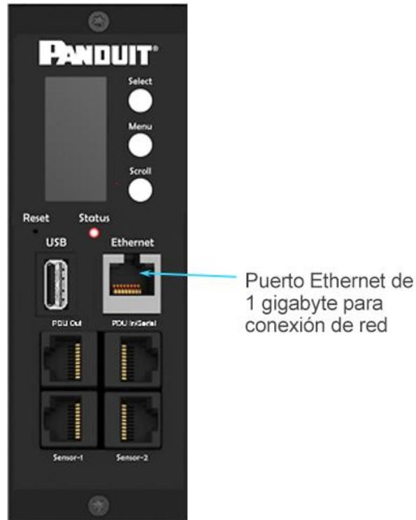
**Figura 1: Puerto Ethernet para conexión de red**
