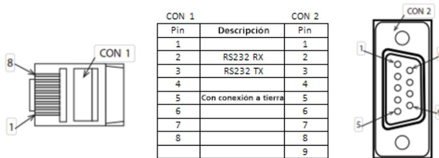
**Figura 22: Pinout del cable serie**
