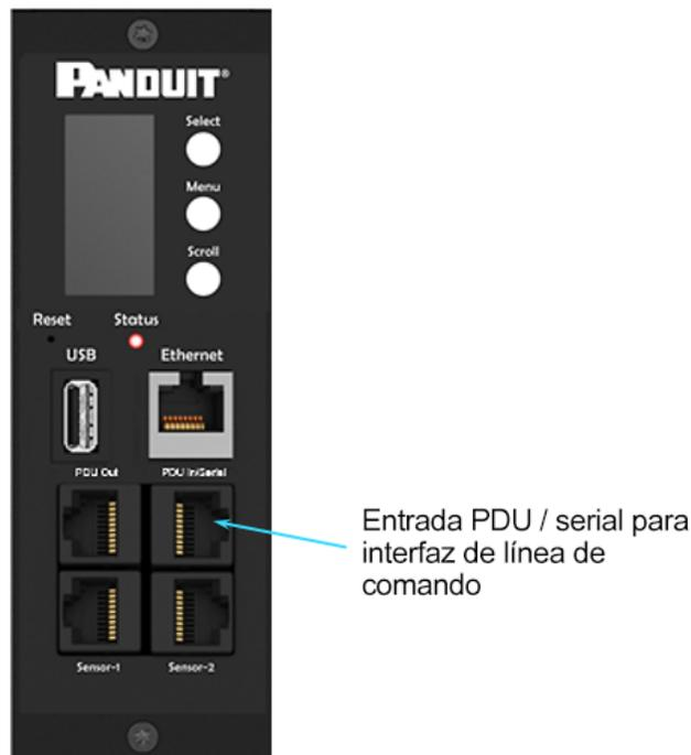
**Figura 21: Conecte el extremo RJ-45 del cable al conector de entrada/serie de la PDU**
